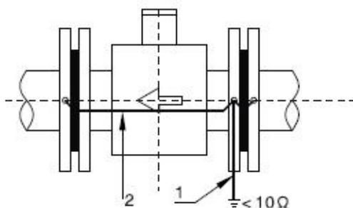
1、接地装置线；2、仪表接地线
