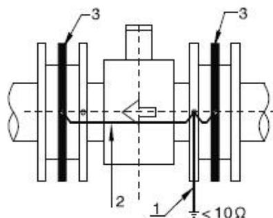
1、接地装置线；2、仪表接地线；3、接地法兰或接地环
