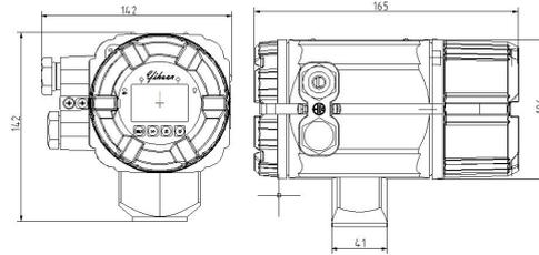
防爆分体型电磁流量转换器外形尺寸
