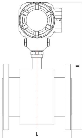
图 5-1 一体型电磁流量计外形
